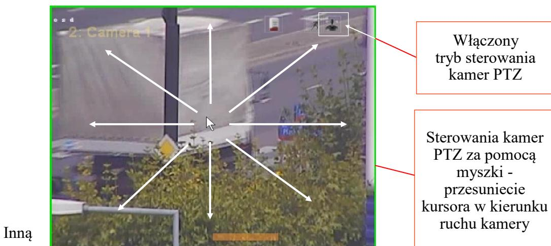
możliwością jest kliknięcie na tej części obrazu która znajduje się na kierunku ruchu kamery np.: aby uzyskać przesunięcie w lewo należy kliknąć w punkt znajdujący się na lewo od środka obrazu. Sterowanie kamer z panelu PTZ opisane jest w rozdziale 9 niniejszej instrukcji.
