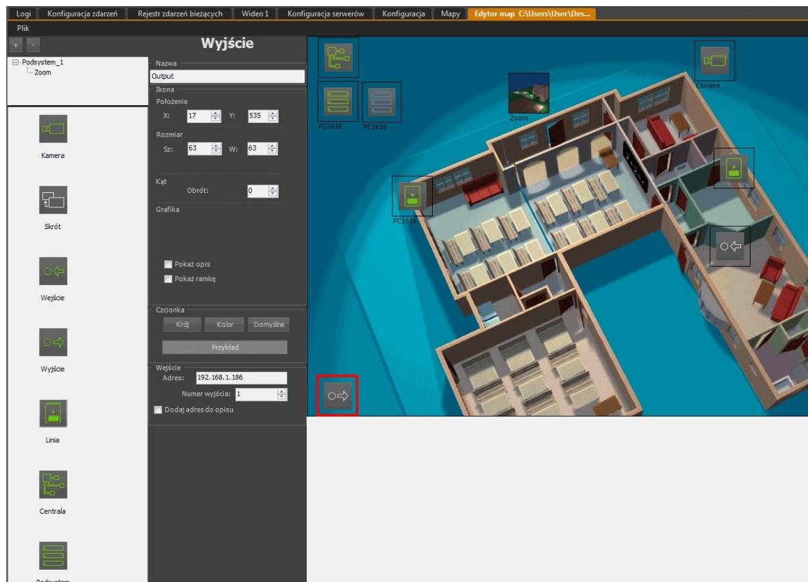
Po umieszczeniu ikon elementów na mapie należy zdefiniować ich parametry. W tym celu należy kolejno kliknąć na każdą z ikon umieszczoną w obszarze projektu i zmodyfikować następujące parametry:
