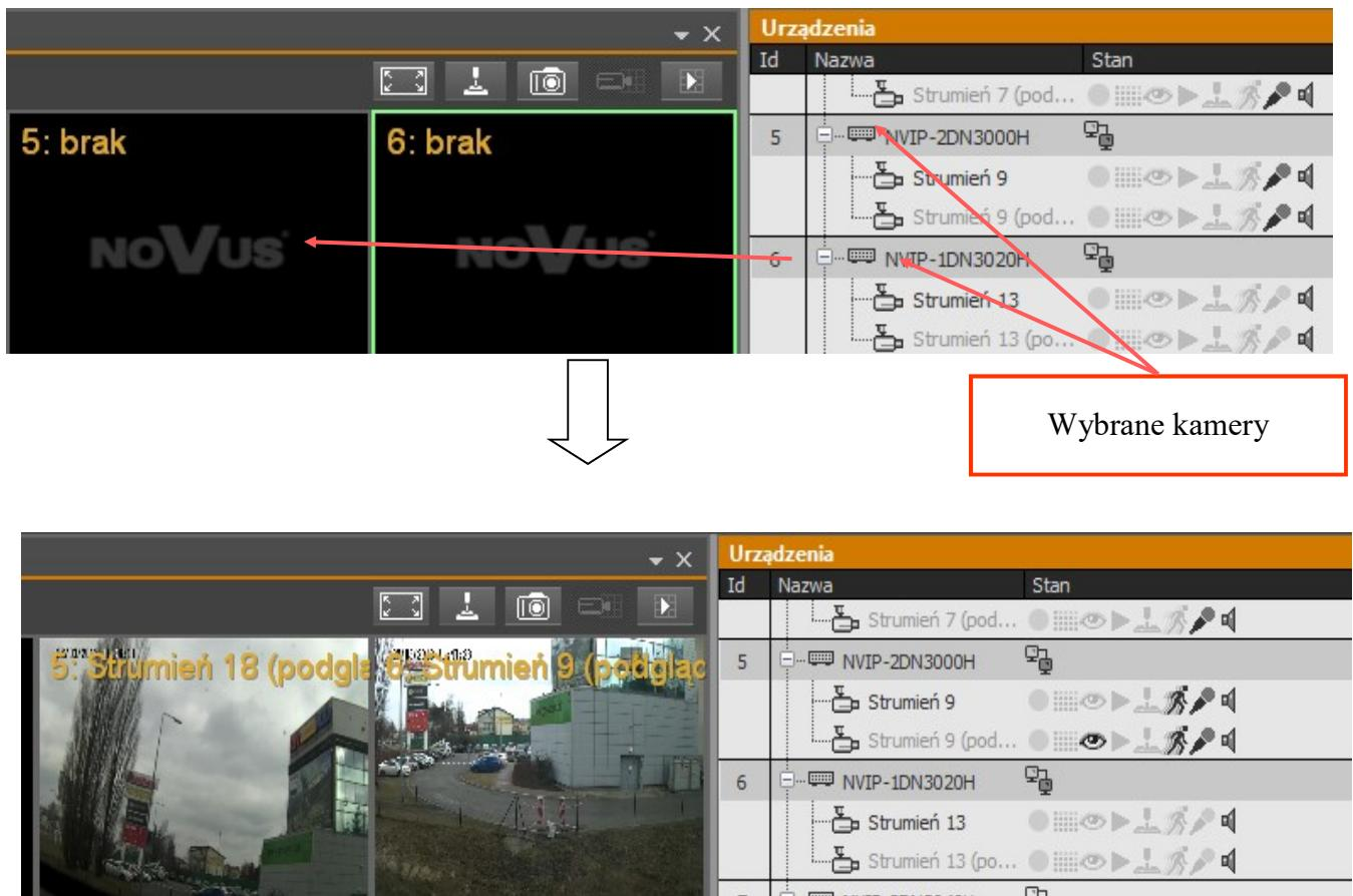
Analogicznie można przeciągnąć serwer NMS VSS by wyświetlić obraz ze wszystkich podłączonych kamer, a nawet kilka zaznaczonych serwerów NMS VSS.
