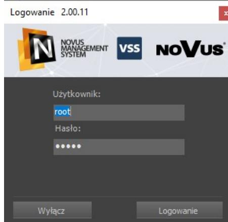
Przycisk *Wyłącz* pozwala na zamknięcie aplikacji NMS VSS, przycisk *Logowanie* uruchamia aplikację. Zamknięcie aplikacji jest możliwe tylko gdy dany użytkownik ma przydzielone uprawnienia do takiej operacji. Naciśnięcie klawisza *Enter* odpowiada naciśnięciu *Logowanie*, a naciśnięcie klawisza *ESC* odpowiada naciśnięciu *Wyłącz*.
