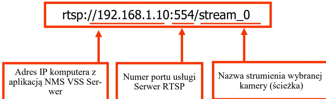
Po prawidłowym wpisaniu ścieżki sieciowej i załadowaniu bufora odtwarzacza obraz z kamery zostanie wyświetlony na ekranie.
