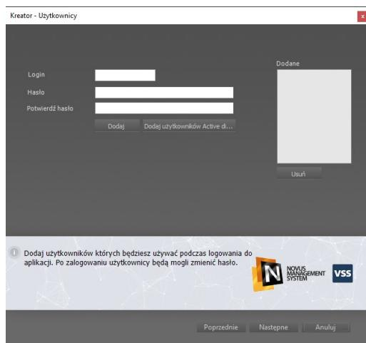
Wprowadzenie danych (login oraz hasło) i wciśnięcie przycisku *Dodaj* dodaje konto do okna o nazwie *DODANE*. W przypadku błędnego wprowadzenia danych możliwe jest usunięcie konta z listy poprzez przycisk *Usuń*.
