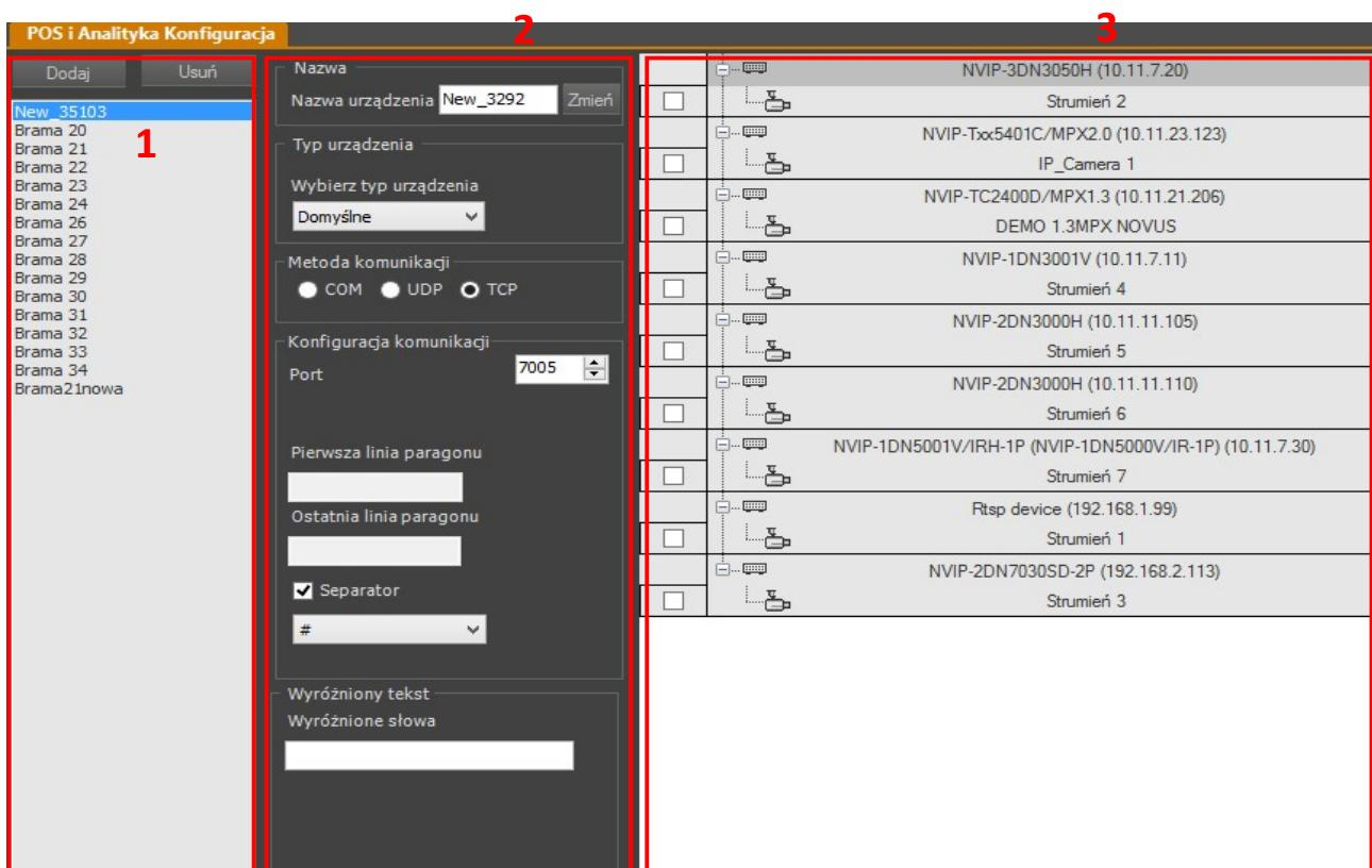
1. W pierwszej umiejscowione są przyciski służące do dodawania i usuwania kas fiskalnych, a także lista wszystkich kas dodanych do systemu. Obecnie edytowane urządzenie podświetlone jest na liście belką.
