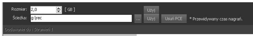
W każdej chwili można zmienić rozmiar dysku przeznaczony do zapisu każdej z kamer. W tym celu wystarczy w panelu *Rejestrator* wpisać zmienioną wartość rozmiaru nagrań dla odpowiedniej kamery i kliknąć przycisk *Zapisz*. Jeśli podana wartość zostanie zmniejszona użytkownik otrzyma komunikat o tym że część danych zostanie utracona.
