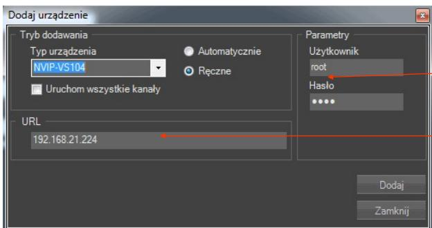
Tryb manualny umożliwia dodanie urządzenia gdy nie jest możliwe jego identyfikowanie w sieci, np. gdy nie zostało jeszcze uruchomione
